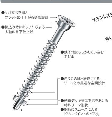
ステンレスSUS410にプロンスが上げたから安心で自然な仕上い! タ人の人が歩く場所等の超硬質テッツキ材の施行に最適!
