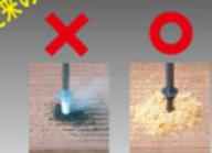
従来は、硬質ウッドデッキ材に対してきり粉の 排出が悪く途中でつまりが生じ、下穴 (バカ穴) をうまく開ける事が出来ず焼け付き、焦げ付き が生じる、あるいはリーマが木質の途中で飛 んでしまい下穴を最後迄開けられない等の不 具合がありました。
